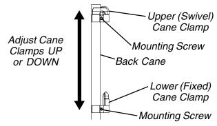
FIGURE 1 - ADJUSTING CANE CLAMP HEIGHT
